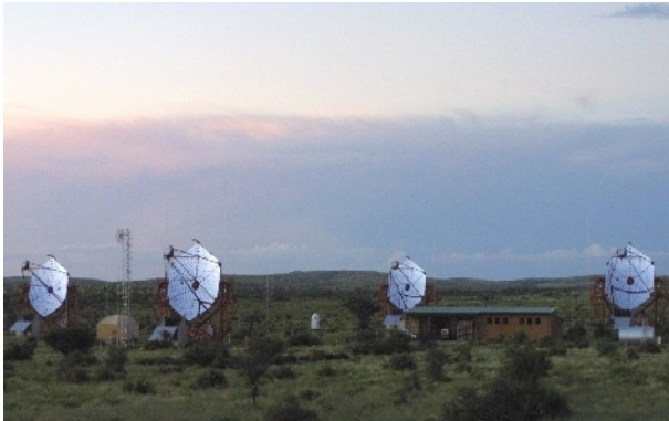
Figure 3.5: L'observatoire HESS (High Energy Stereoscopic System) en Namibie comporte quatre télescopes aux coins d'un carré de 120 \times 120 m 2 et détecte des photons d'énergies dépassant les 100 GeV. Son champ de vision est de 5^\circ et sa résolution angulaire de quelques arc minutes. Il suffit de 30 secondes pour prendre une image du Crabe.
